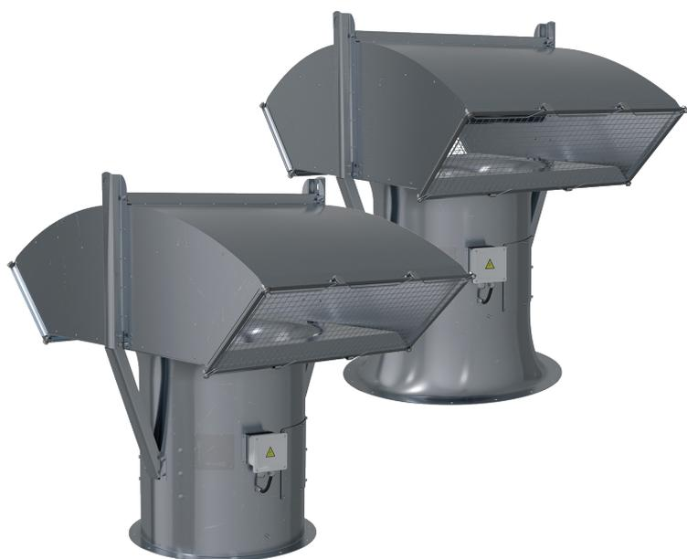
Вентиляторы ВОП-20, ВОП-30 применяются для подпора воздуха в системах противопожарной защиты и выпускаются в общепромышленном исполнении. Они предназначены для подачи воздуха в обслуживаемые помещения, шахты лифтов, лестничные клетки, тамбур-шлюзы, для предотвращения проникновения продуктов горения на пути эвакуации людей.
